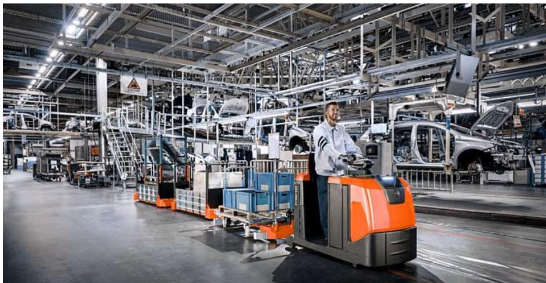
Figura 8: Tren d'aprovisionament. Font: Anònim. Tractores de arrastre para transportar artículos individuales. en el momento preciso. Toyota Material Handling España. ( https://toyota-forklifts.es/soluciones/su-sector/fabricacion/ , 24 d'abril de 2022)
