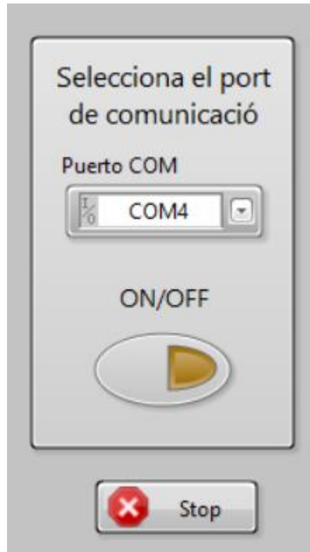
Figura 125 - Selector port de comunicacions de l'equip, botó ON/OFF de la mesura i botó Stop.
