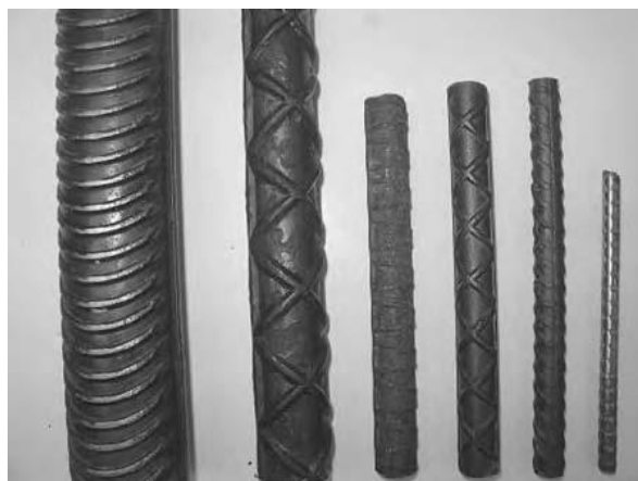
Figura 4.1. Exemples d'armadures deformades amb diferents configuracions [2]
