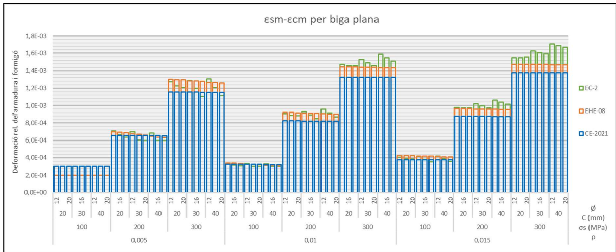
Gràfic 19: Deformació de l'armat per biga plana, en funció de cada normativa
