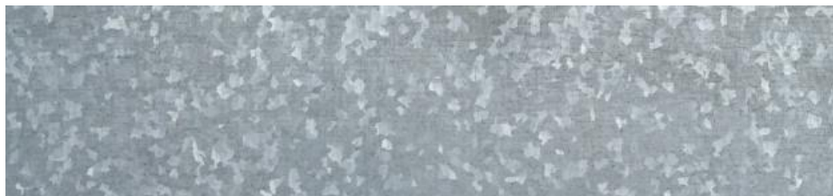
Figura 29: Textura acer amb acabat galvanitzat.
