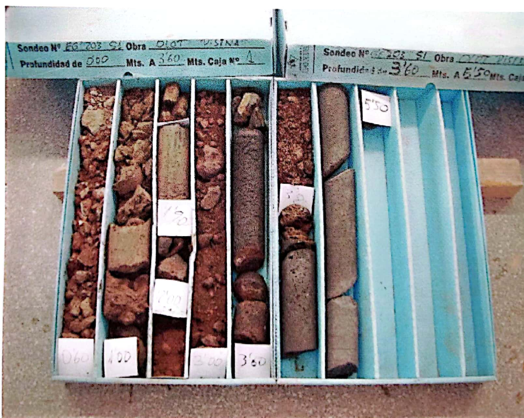
Caixes de testimonis corresponents al sondatge S-1 (0-5,50 m)
