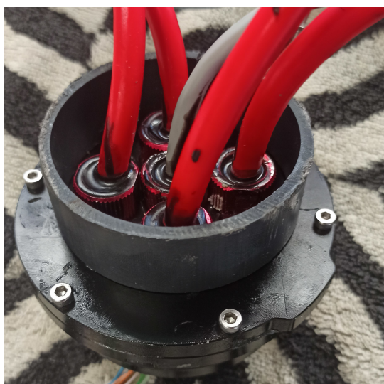
Figura 45: Penetradors amb resina.
