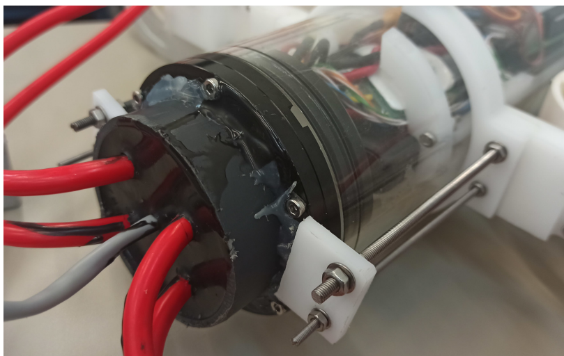
Figura 58: Tapa posterior de la carcassa amb els tancadors
