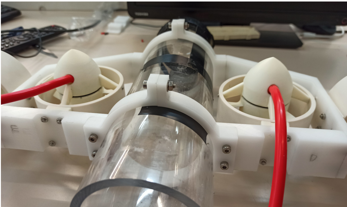
Figura 37: Esquelet unit al compartiment estanc.
