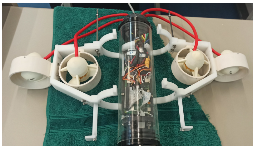
Figura 57: Carcassa amb l'esquelet abans de ser muntat
