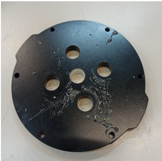
Figura 24: Tapa d'alumini amb un nou forat al mig
