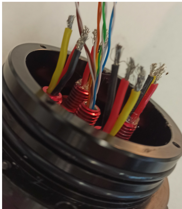
Figura 44: Cables introduïts pels penetradors. Part interior.
