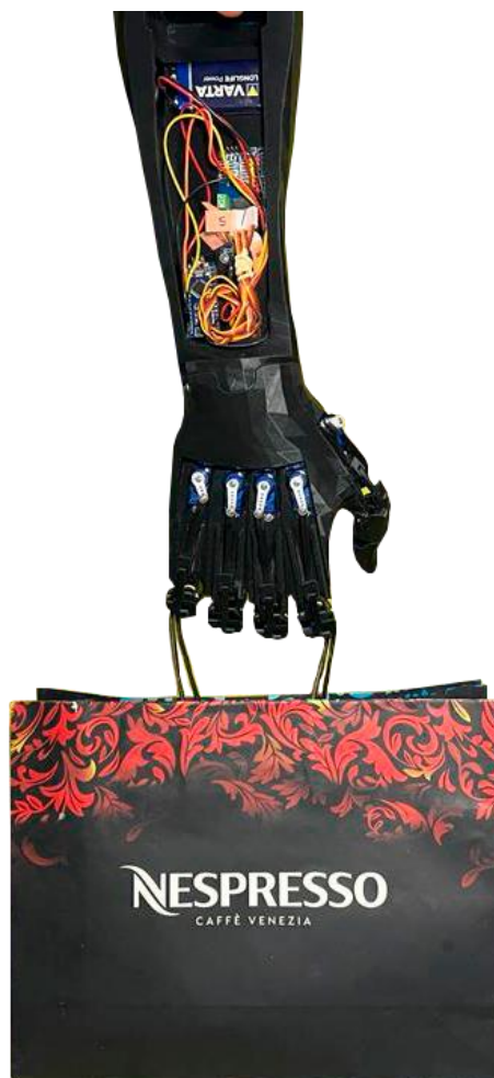
Figura 6: Subjecció d'una bossa mitjançant el prototip
