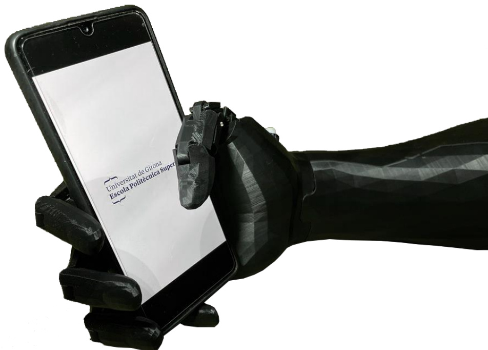
Figura 3: Subjecció d'un telèfon mòbil mitjançant el prototip
