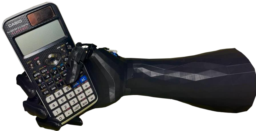
Figura 5: Subjecció d'una calculadora mitjançant el prototip
