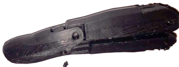
Figura 20: Ruptura del primer disseny d'unions
