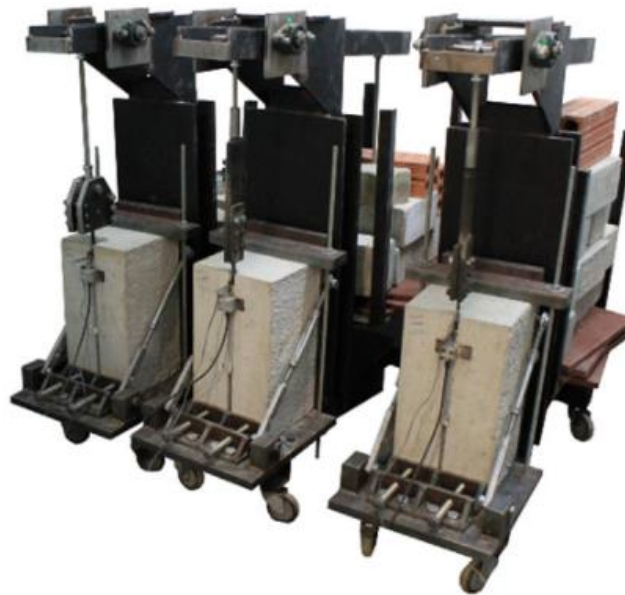
Figura 16: Muntatge de l'assaig a llarg termini experimental [13]
