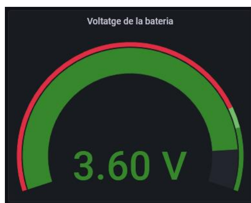
Figura 37 Gauge Voltatge de la bateria
