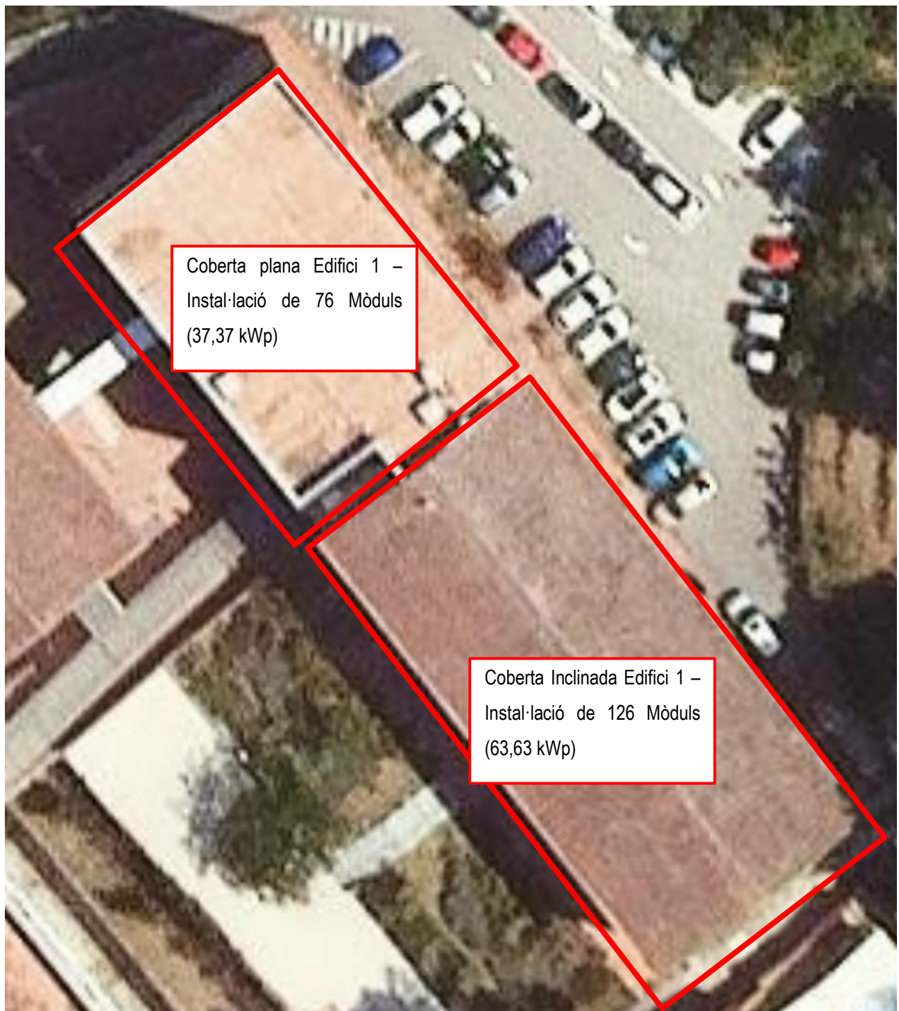
Figura 4. Cobertes de l'edifici 1
