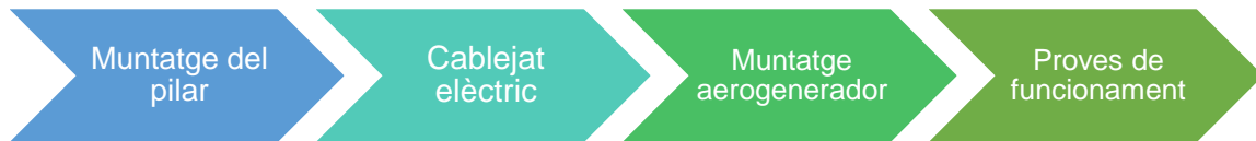
Figura 1. Procés de muntatge de l'aerogenerador
