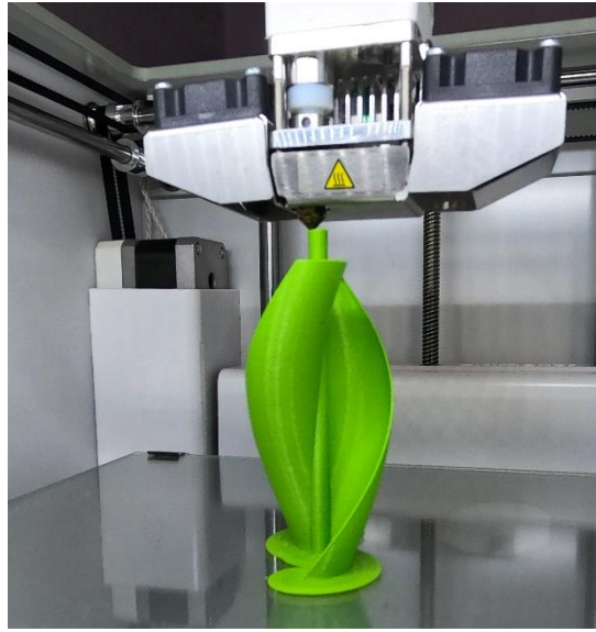
Figura 11. Conjunt de pales i eix de l'aerogenerador imperès en 3D. Font pròpia
