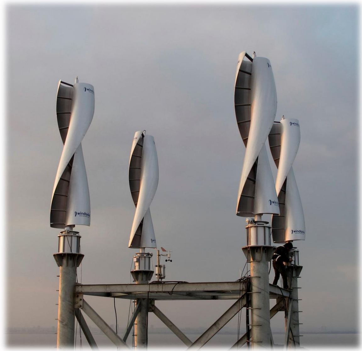
Conjunt de turbines eòliques tipus Savonius helicoidal. Font: Windside
