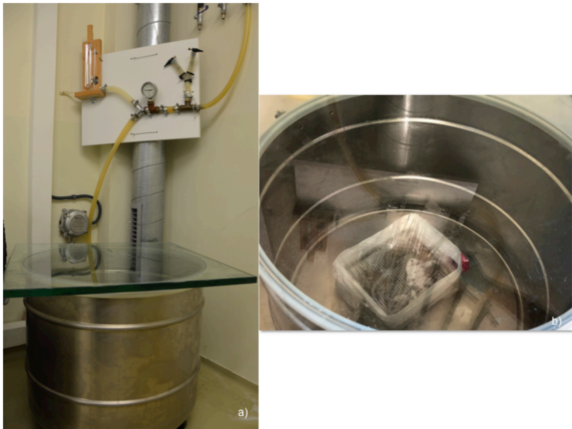
Figura 35. Fase de impregnación. a) Tanque de acero donde se realiza el vacío tras introducir las piezas ya tratadas. b) Las muestras está cubiertas con la resina Epoxi-E-12/E1 dentro del cubículo donde se controlan las presiones recibidas
