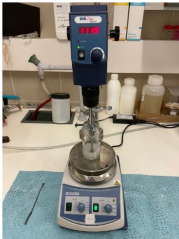
Figura 6-12. Il·lustració sistema de placa calefactors més agitador mecànic. Font: pròpia.
