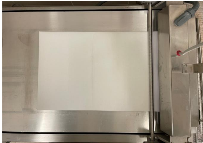
Figura 6-31. Mostres col·locades i fixades a l'aplicador. Font: pròpia.
