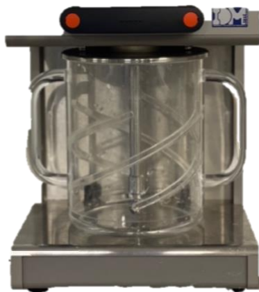
Figura 6-3. Il·lustració del pulper. Font: pròpia.
