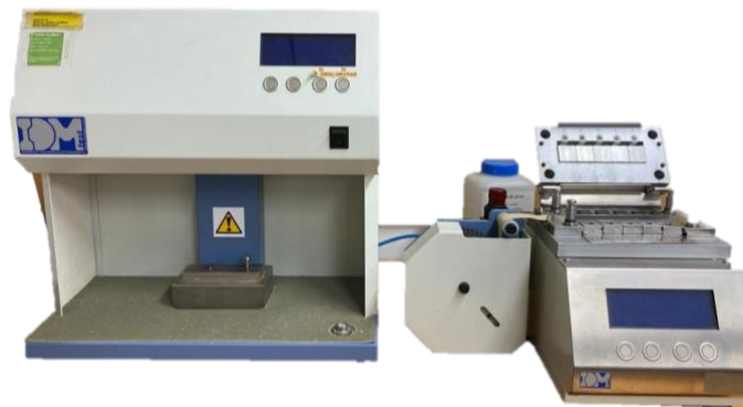
Figura 6-21. Il·lustració equip Scott-Bond. Font: pròpia.
