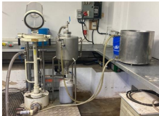
Figura 6-6. Il·lustració del sistema de filtració, bomba i pulmó. Font: pròpia.
