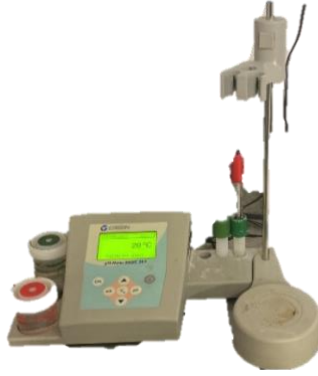
Figura 6-5. Il·lustració pH-metre. Font: pròpia.
