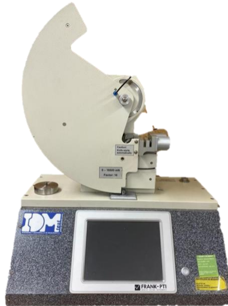
Figura 6-24. Il·lustració equip Elmendorf. Font: pròpia.
