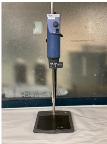
Figura 6-8. Il·lustració ultra-turrax. Font: pròpia.
