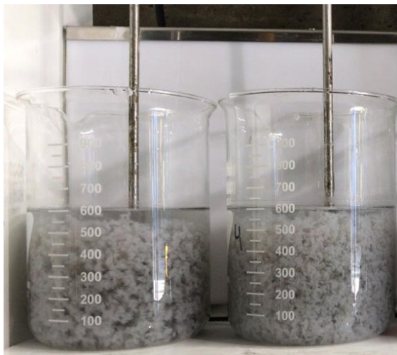
Figura 27 Imatge final de floculació de les proves realitzades amb DKFLOCK 1010
