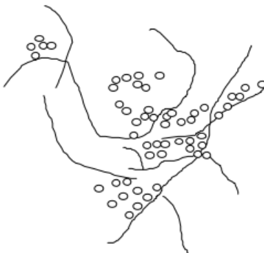
Figura 10 Pont generat per el floculant entre els micro-flòculs [2].
