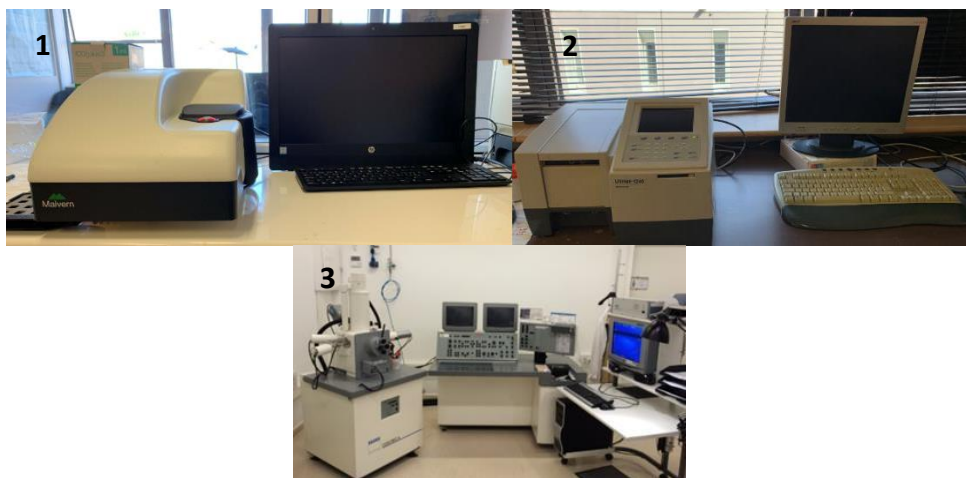
Imatge 2. Equips utilitzats per a la caracterització de AgNP: DLS, UV-Vis, SEM.
