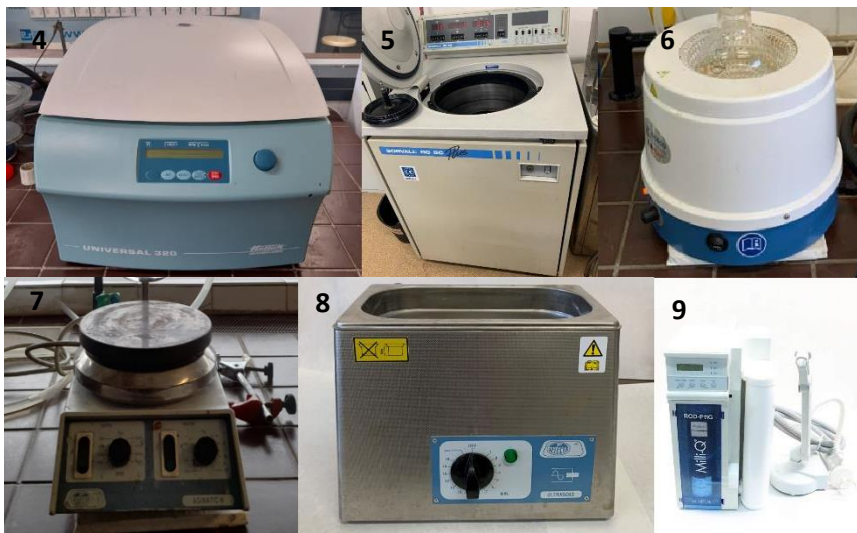
Imatge 3. Centrífuga (2380g) , centrífuga (15000g), manta calefactors, placa calefactors + agitació, bany d'ultrasons i dispensador d'aigua Milli-Q.
