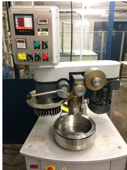
Figura 2-2: Molí PFI utilitzat per refinar les pastes de paper.
