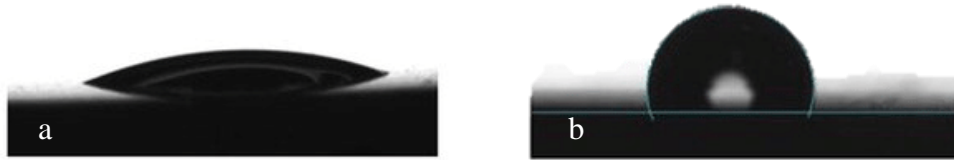
Figura 3-12: Angle de contacte de suports sense AKD (a) i amb AKD (b).
