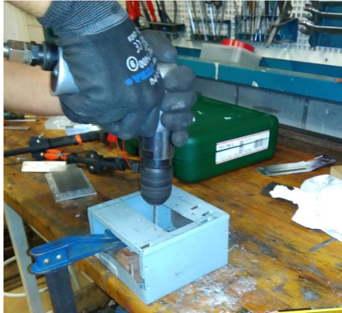
Figura 23: berbiquí pneumàtic per foradar la caixa principal.
