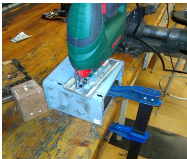
Figura 22: Serra de calar mentre forada la obertura per els mòduls.
