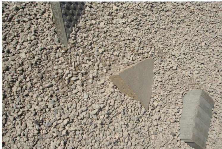
Figura 44: Àrids reciclats procedents de la trituració de residus de formigó. Font: https://www.xirgu.net/planta-de-reciclatge-1/arids-reciclats/formigo/
