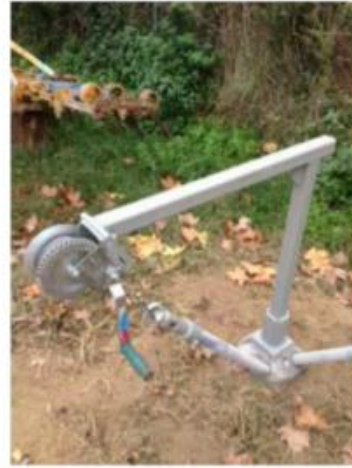
Figura 7.7: Herramienta especial de desinstalación.
