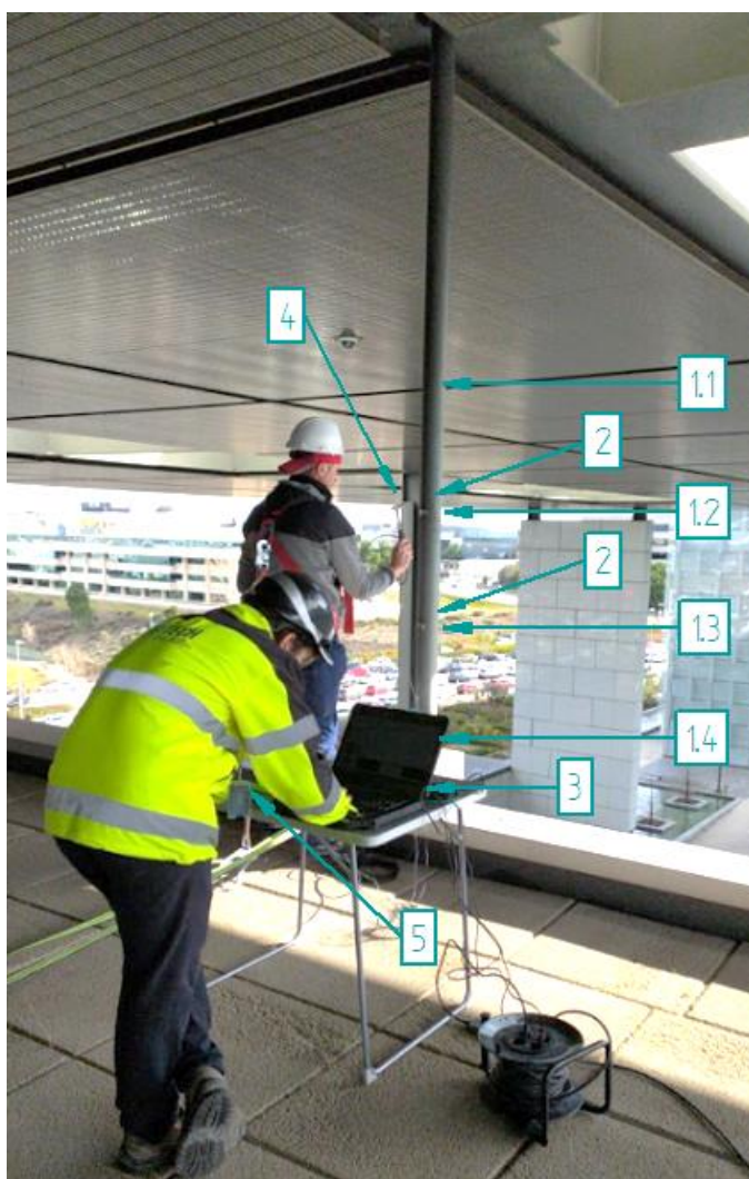
1.n- Punt d'impacte; 2- Acceleròmetre; 3- Portàtil; 4- Martell d'impacte; 5- Analitzador de senyal.
