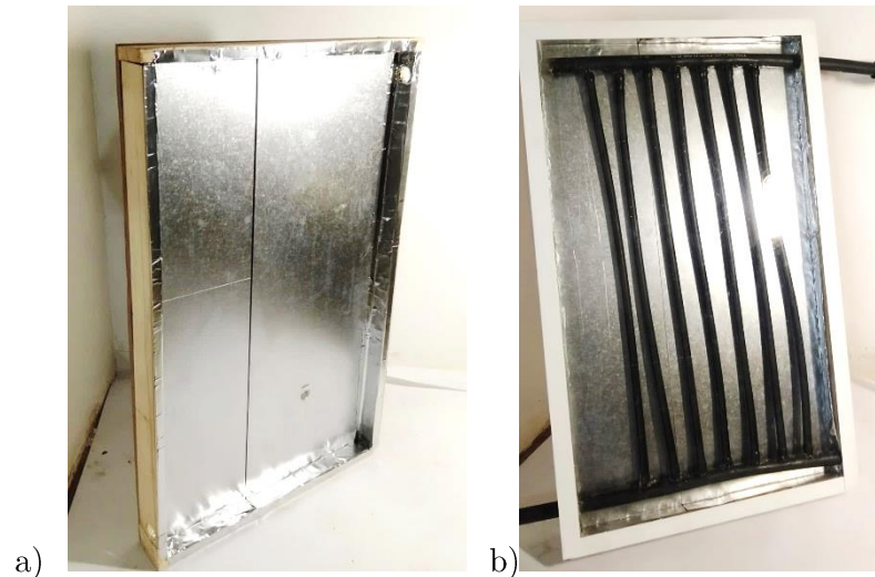
Figura 83. Resultat del col·lector: a) mostrant la part interior i b) amb tot el conjunt.
