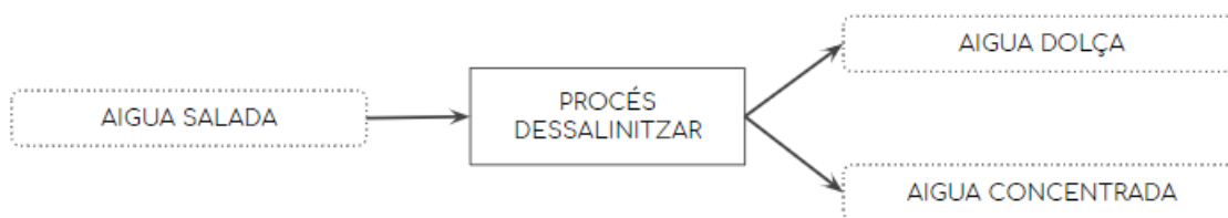
Figura 12. Diagrama de flux de la dessalinització.
