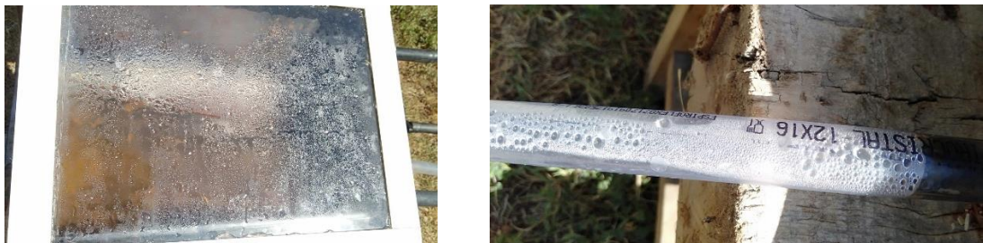
Figura 88. Gotes de l'evaporació i condensació del prototip.
