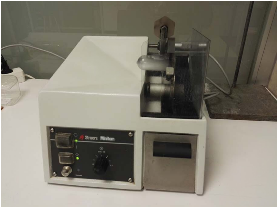
Figura 42: Fotografia de la serra de precisió mentre talla la preforma per a obtenir l'anell de 0,62mm.
