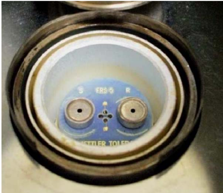
Figura 30: Forn de l'equip Mettler Toledo utilitzat per estabilitzar la mostra PET B2, m=5'036\text{mg} .
