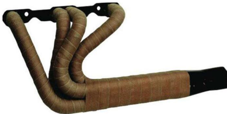
Figura 50: Col·lectors d'admissió envoltats amb cinta anticalòrica (Thermotec. 2015).
