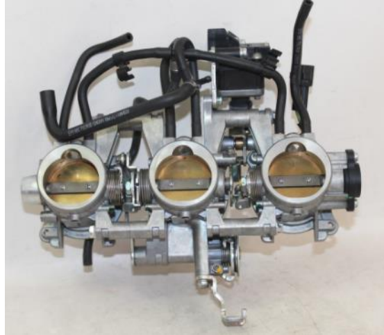
Figura 15: Admissió de moto amb geometria particular (Imperial sports bikes. 2015).
