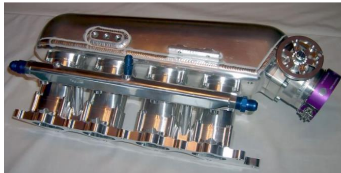
Figura 5: Conjunt de col·lectors d'admissió i papallona (Hypertune. 2015).
