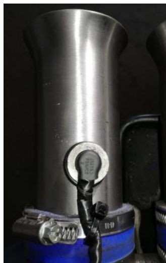
Figura 25: Sonda de temperatura col·locada a la trompeta (Gudayol, M. 2017).
