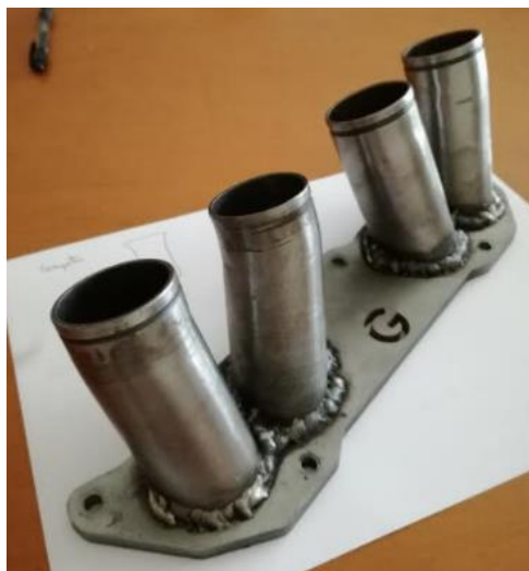
Figura 57: Col·lectors d'admissió fabricats (Gudayol, M. 2017).
