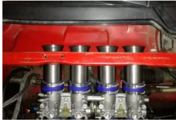
Figura 33: Disposició de les trompetes dins la caixa d'aire (Gudayol, M. 2017).
