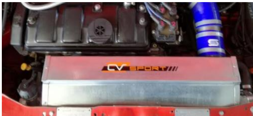
Figura 68: Campana d'admissió en la seva posició final (Gudayol, M. 2017).
