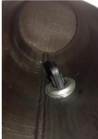
Figura 42: Vista interior del suport i sonda, incorporats en una de les trompetes (Gudayol, M. 2017).
