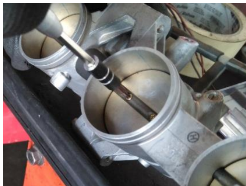
Figura 52: Procés de desmuntatge de la segona papallona (Gudayol, M. 2017).
