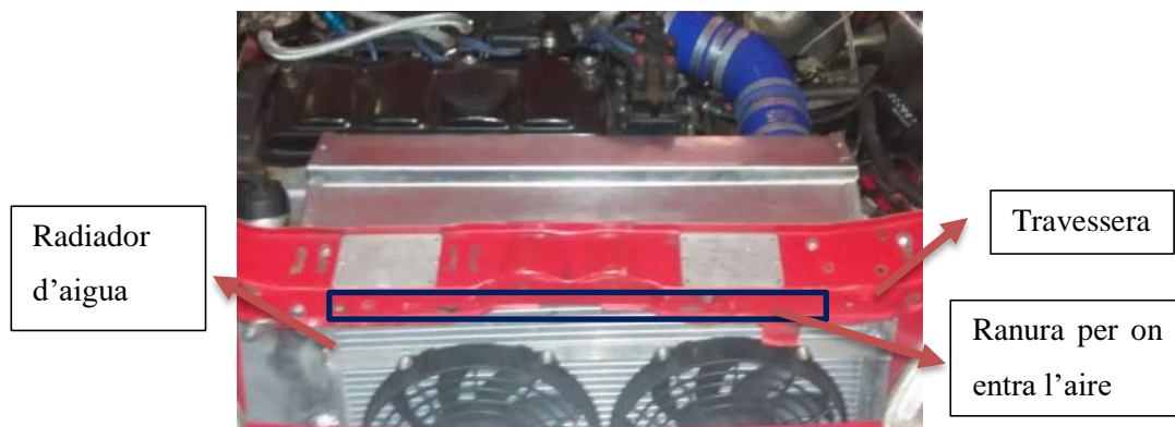
Figura 47: Ranura per la qual entra aire a la campana (Gudayol, M. 2017).
