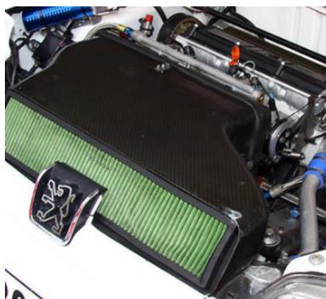
Figura 48: Filtre d'aire col·locat a la campana (Kitsdefibra. 2011).
