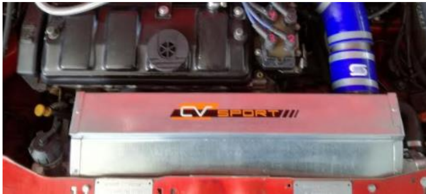
Figura 49: Campana d'admissió en la posició final (Gudayol, M. 2017).
