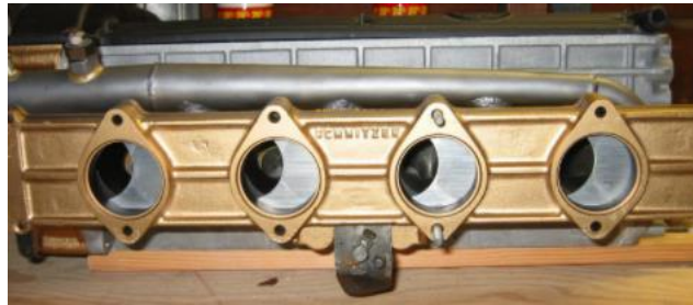
Figura 1: Papallones individuals de desplaçament lateral o "Guillotina" (Marckmac. 2012).
