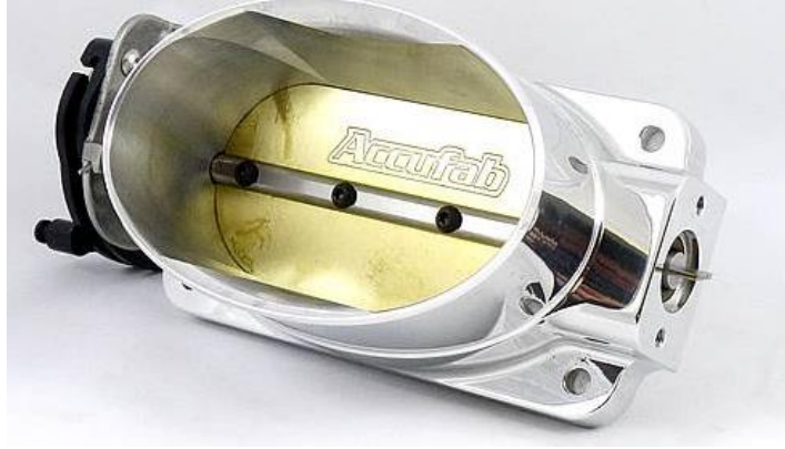
Figura 4: Cos d'admissió en forma ovalada (Accufabracings. 2015).
