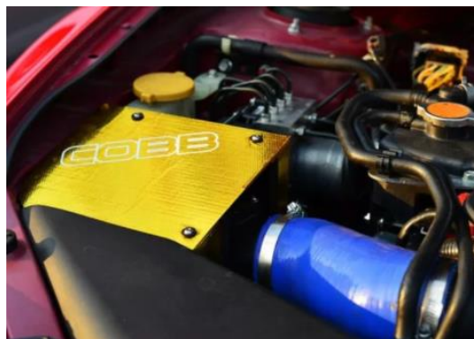
Figura 46: Campana amb aïllament anticalòric (Cobb Tuning. 2011).
