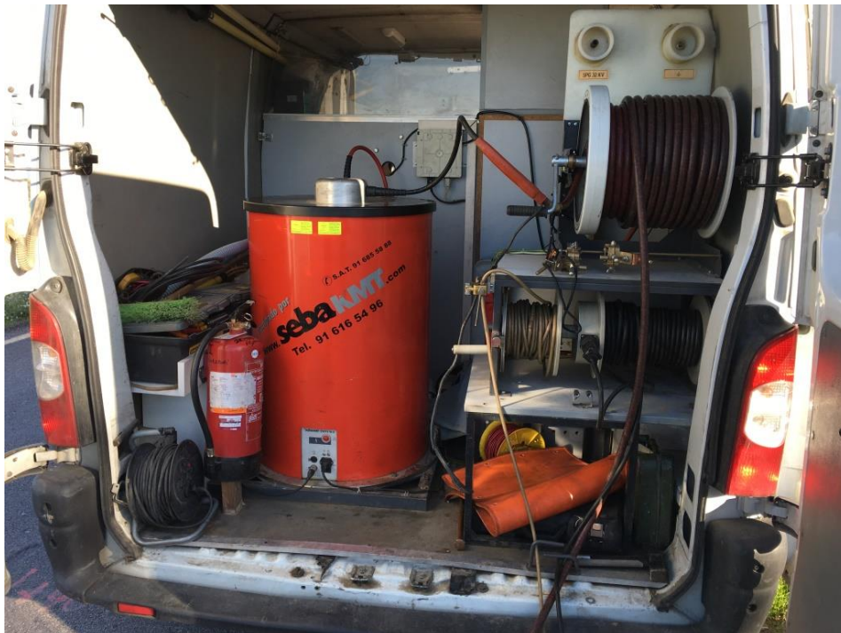
Figura 5: Part posterior del laboratori mòbil on es situa la bobina d'ona ressonant de 60kV
