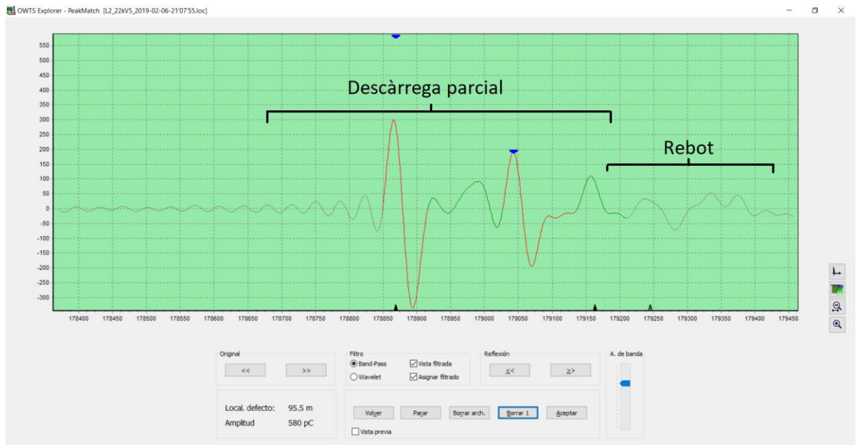
Figura 18: Descàrrega parcial de 22k5 V amb defecte en la coberta, generant una amplitud d'ona màxima de 580pC
