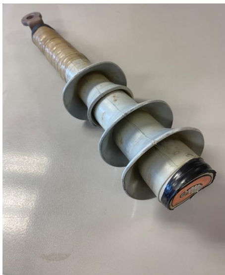
Figura 12: Terminal de línia en bon estat d'un cable de mitja tensió soterrat
