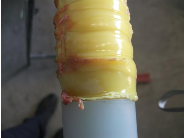
Figura 9: Pasta aïllant de reomplert entre l'aïllament i el maneguet de connexió
