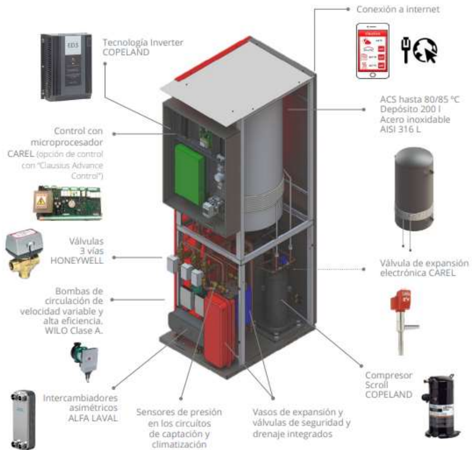
Figura 24. Esquema interior de la bomba de calor Clausius 3-15 H. Font: Clausius.
