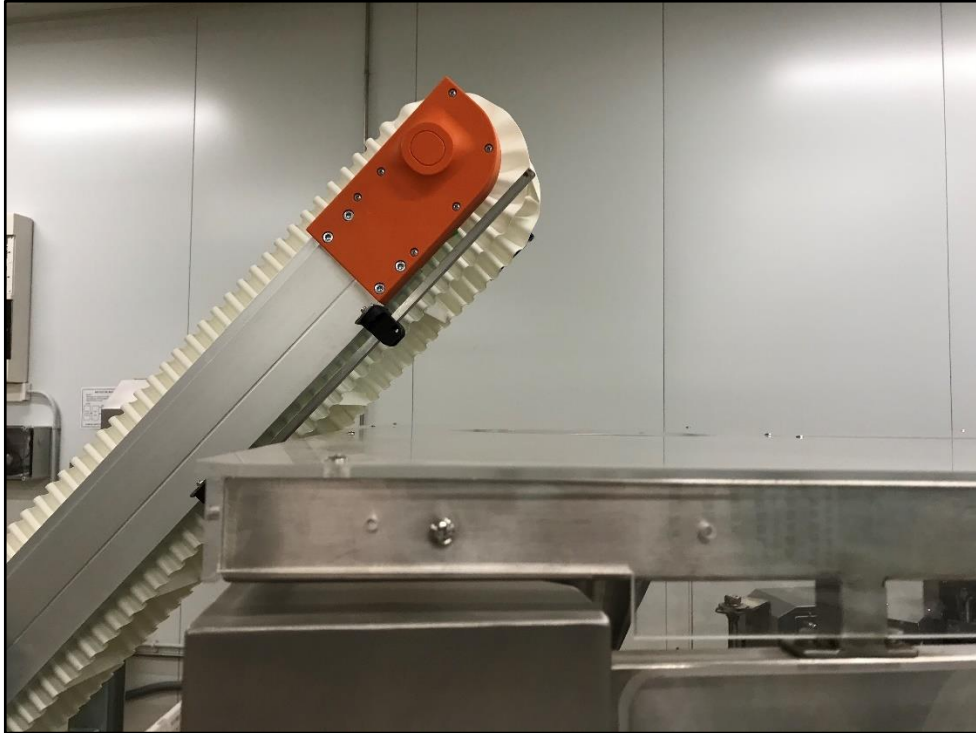
Figura 16. Alçada entre la cinta d'alimentació i el dispensador
