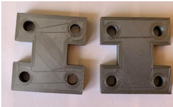
Figura 17. Disseny final ancoratges PLA
