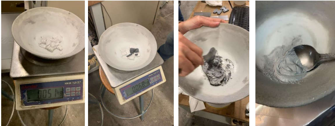
Figura 59. Preparació Epoxi
