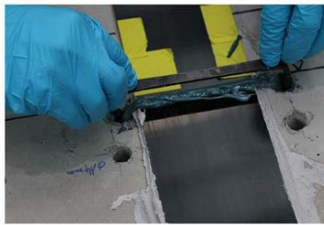
Figura 10. A) U-ancoratge B) Col·locació del U-ancoratge (Moshiri & Czaderski, 2020)
