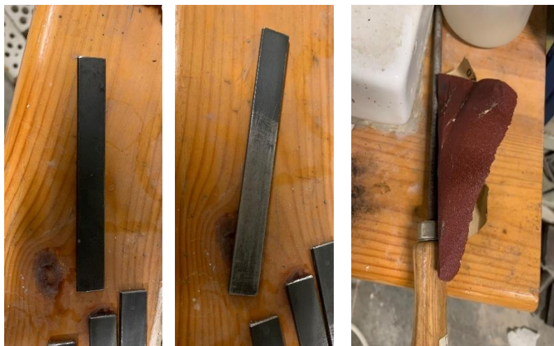
Figura 61. Preparació zona adherència MAB2
