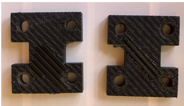
Figura 18. Disseny final ancoratges ABS
