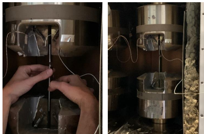
Figura 22. Col·locació del muntatge a la maquina d'assaig
