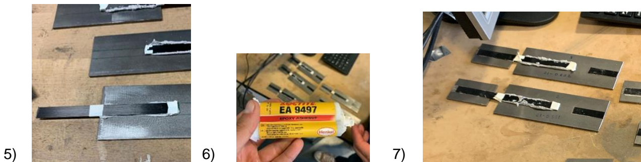
Figura 60. Fixació de la resina al MAB1
