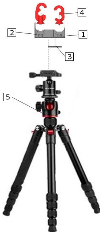
Figura 4: Desglossament en peces de la solució final. Peça 1 és la part mòbil, Peça 2 la fixe, Peça 3 les dues molles i la Peça 4 la flexible del CS. Llavors la Peça 5 és trípode que formen CU i CB junts.
