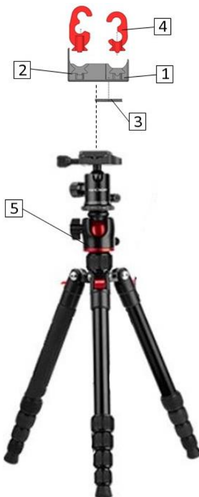
Figura 21: (1)Part mòbil, (2)Part fixe, (3)Molles, (4)Part flexible i (5)Trípodde comercial.
