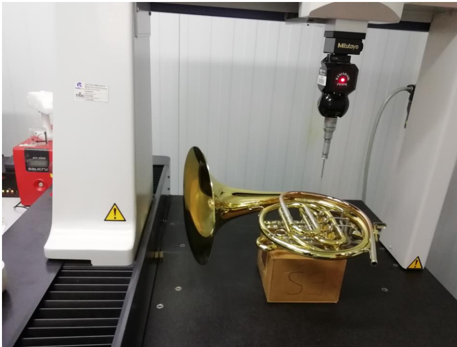
Figura 26: Imatge on s'observa el moment en que es mesura els tubs interns de la trompa amb la màquina de mesurament per coordenades.
