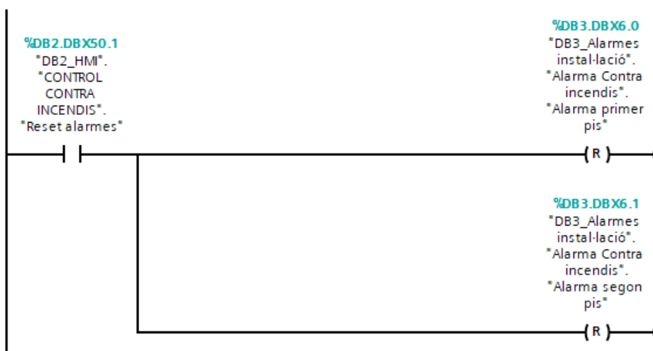
Figura 83. Reset alarmes foc
