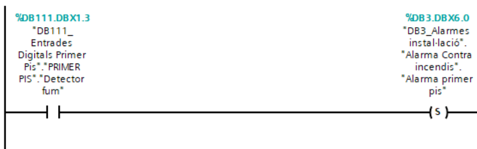
Figura 81. Alarma detecció foc primer pis
