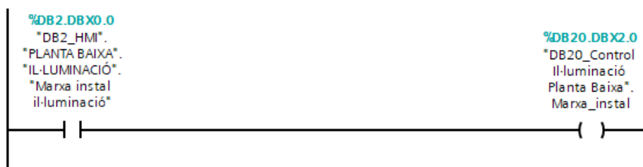
Figura 54. Marxa instal·lació control il·luminació Planta Baixa
