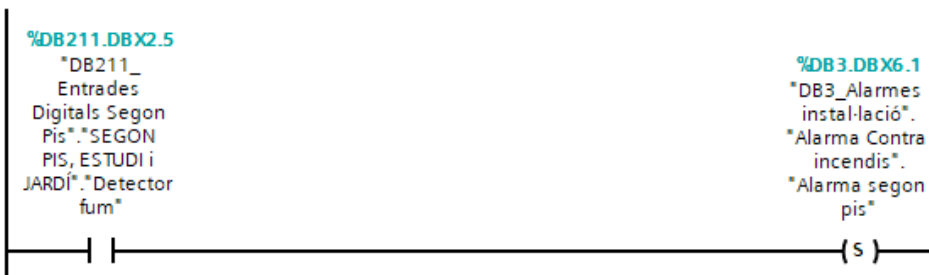
Figura 82. Alarma detecció foc segon pis
