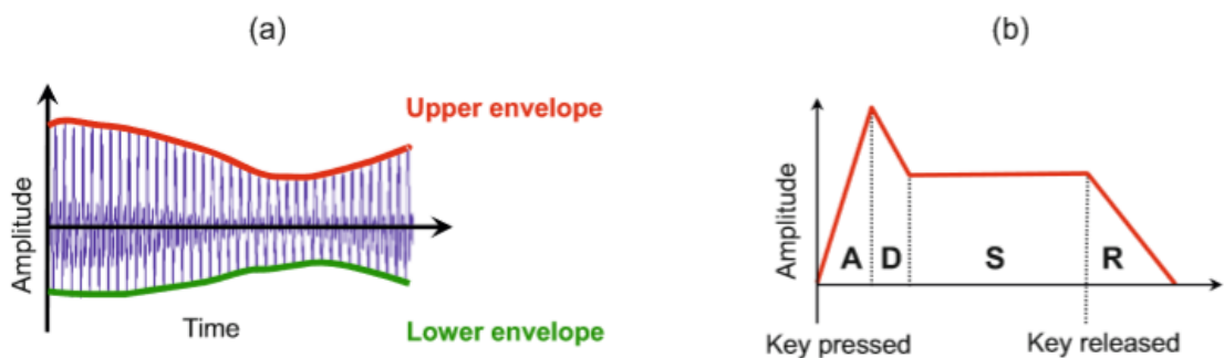
Figura 9: (a) Envolvent del senyal. (b) Vista esquemàtica de l'envolvent ADSR (Müller, 2015).
