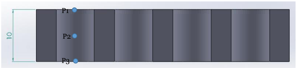
Figura 8. Alçades on s'han pres les mesures dels diàmetres dels forats
