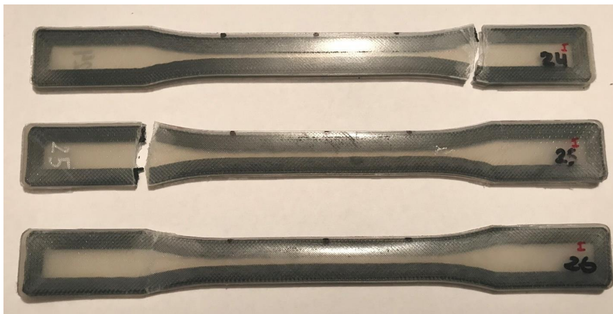
Figura 63. Trencament de les provetes ASTM D638 TYPE I combinació 1
