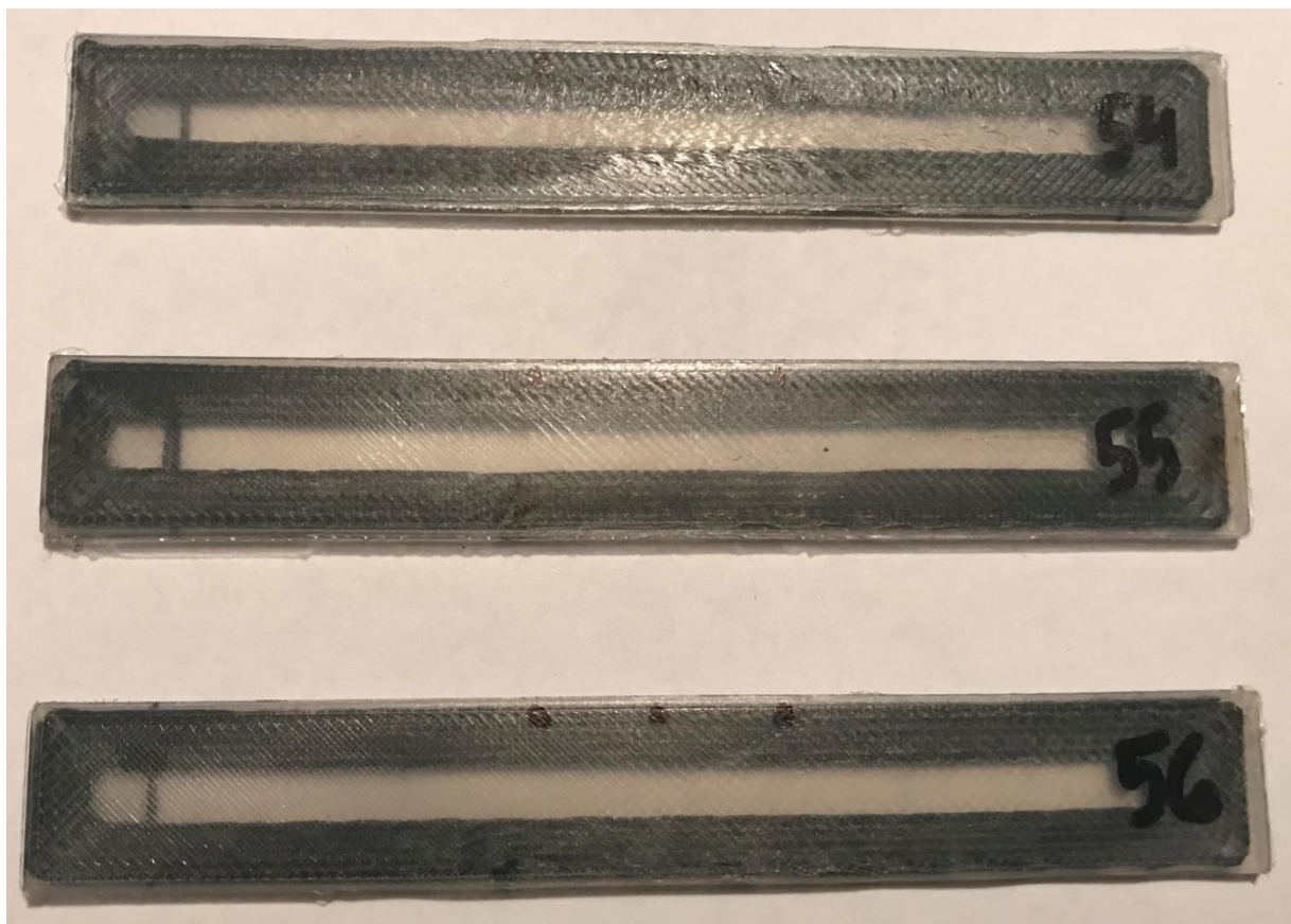
Figura 73. Trencament de les provetes ISO 14125 CLASS IV combinació 2
