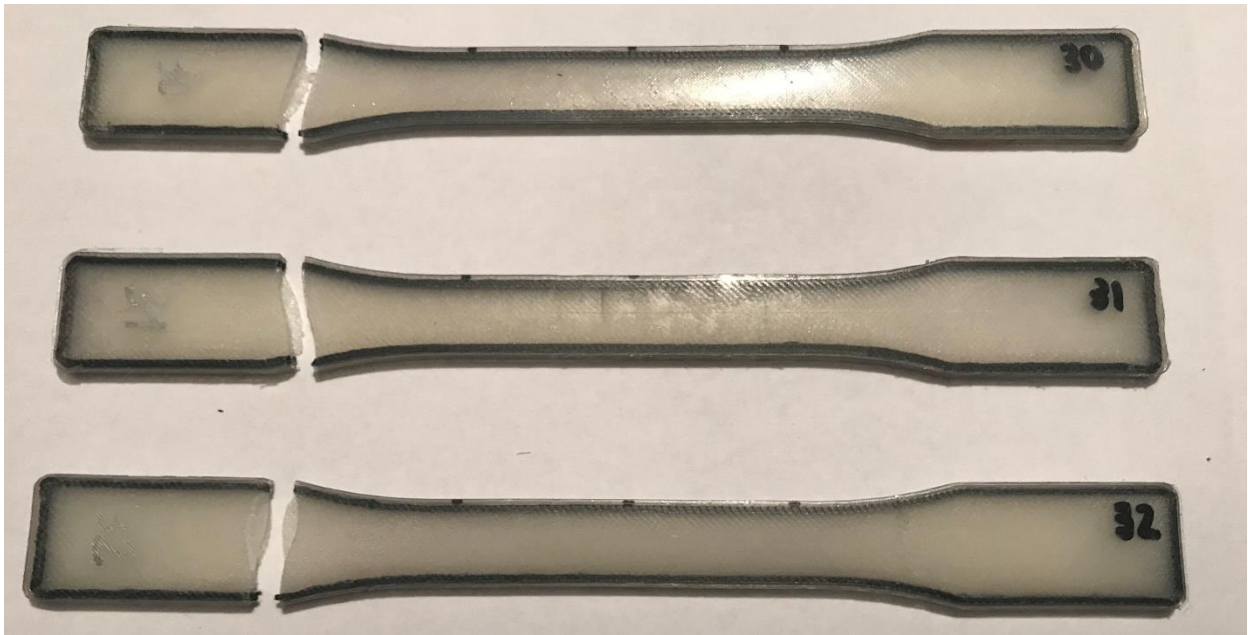
Figura 65. Trencament de les provetes ASTM D638 TYPE I combinació 3
