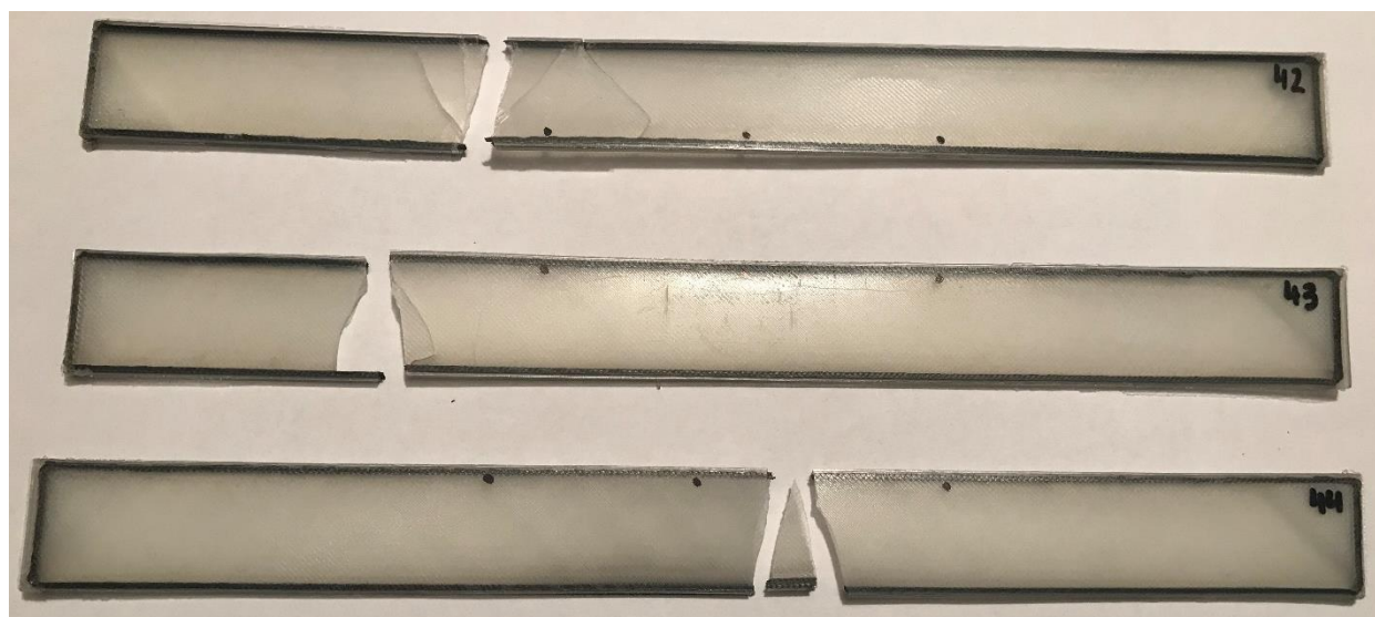
Figura 69. Trencament de les provetes ASTM D3039 BALANCED AND SYMETRIC combinació 3
