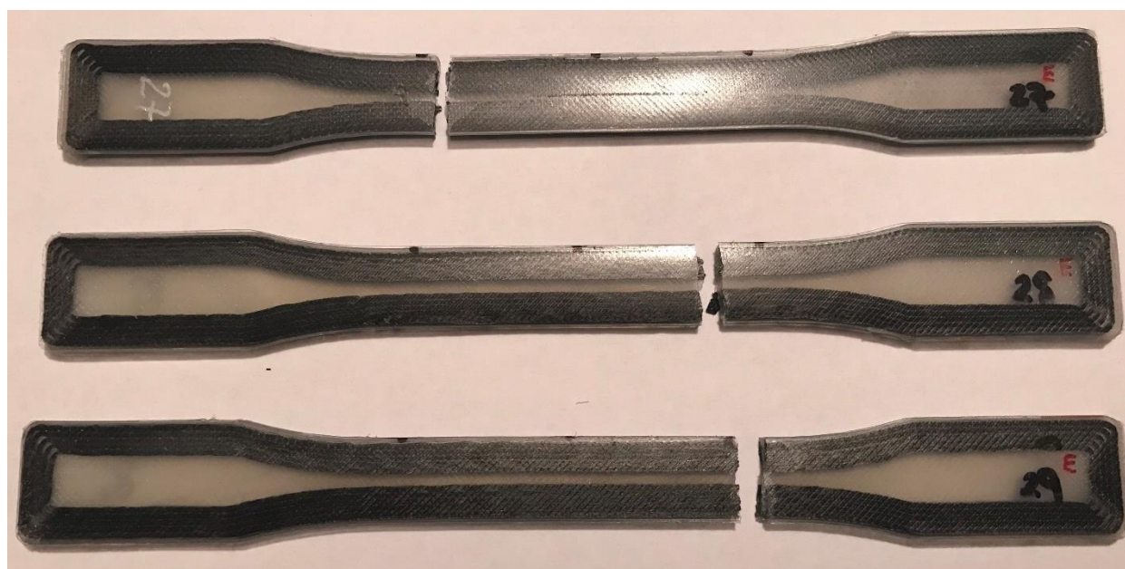
Figura 64. Trencament de les provetes ASTM D638 TYPE I combinació 2
