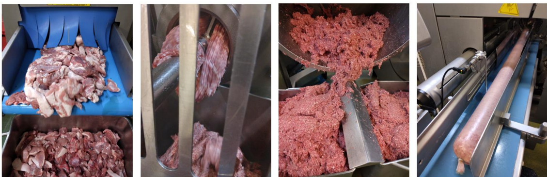
Figura 22 Procés d'elaboració dels lots, mesura i correcció del greix, picat, amassat i embotit
