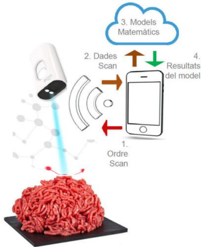
Figura 17 Esquema funcionament NIR SCIO (IRTA, 2018)
