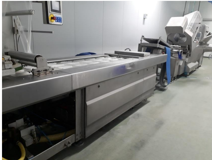
Figura 10. Sala blanca corresponent a la sala llescats 1. Inclou termoformadora, llescadora i envasadora.
