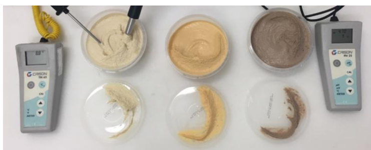
Figura 14. Determinació del pH d'hummus comercials.
