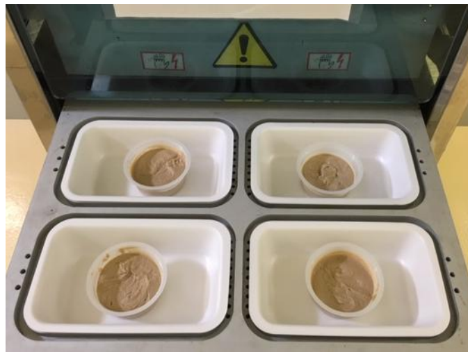
Figura 13. Envasament de l'humus de lleties amb seitó durant l'escalat semi-industrial amb una envasadora ULMA Smart 500.
