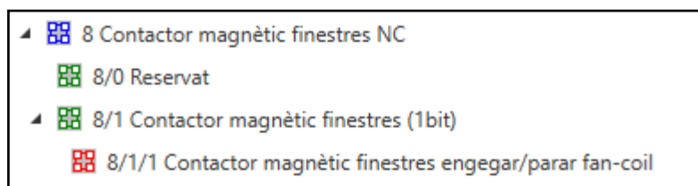
Figura 56. Adreça de grup contactor magnètic de finestres NC
