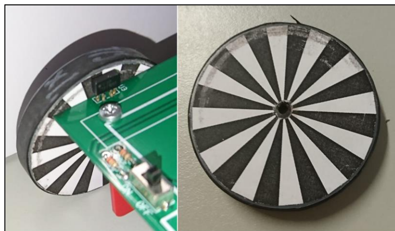
Figura 16. Roda actual de l'Ardubot desgastada.
