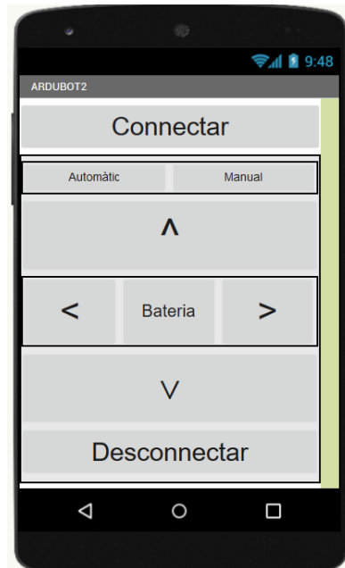
Il·lustració 26. Pantalla que es mostra a la pàgina d'AppInventor amb el programa per a moure el robot.
