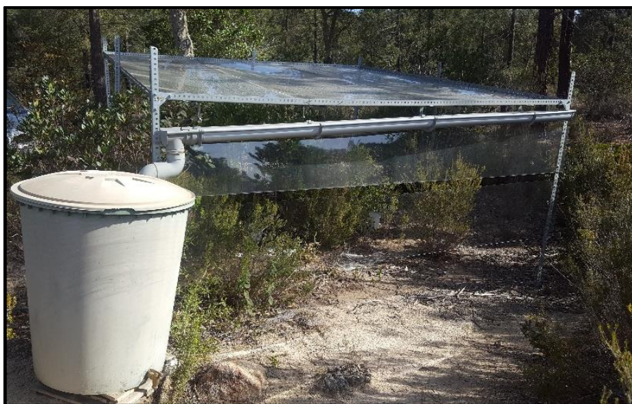
Figura 2.2 Imagen de una de las parcelas instaladas en la zona experimental. Las parcelas fueron construidas con estructuras de metal que soportaban plásticos que actuaban como filtros de distintas longitudes de onda dentro del rango de la radiación UV. El agua de lluvia se recogía a través de un canal y se almacenaba en tanques situados al lado de las parcelas.
