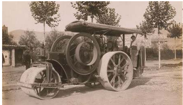
Figura 504. La màquina piconadora Austin Manufacturing & Cº de Chicago (Roisin 1918).
