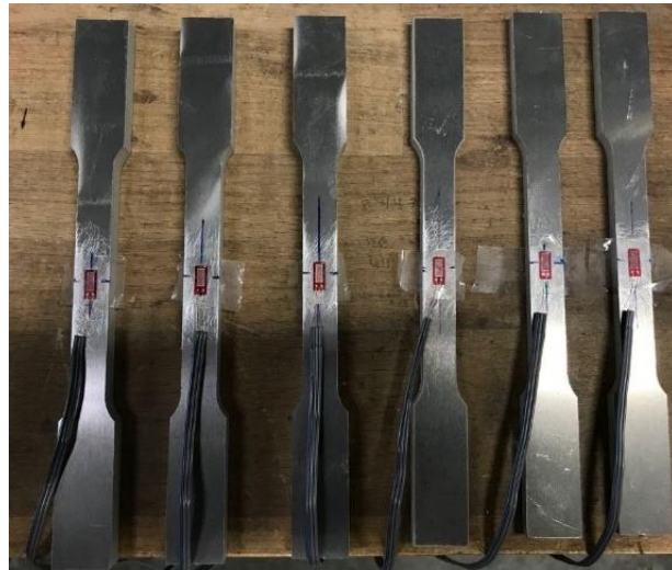
Figura 69 – Provetes utilitzades per a determinar les propietats mecàniques de l'alumini
