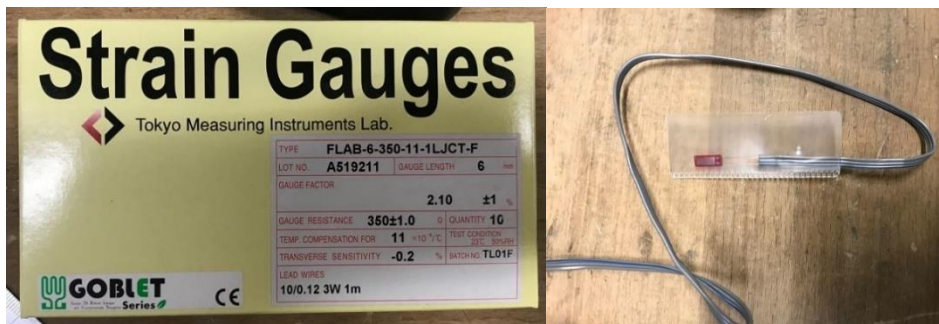
Figura 32 – Característiques principals de les galgues utilitzades (esquerra) i galga extensomètrica (dreta)
