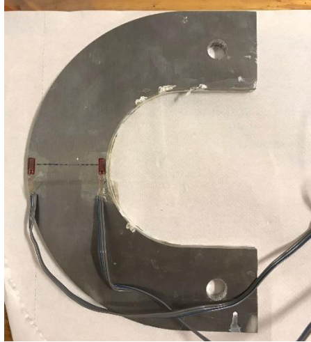
Figura 35 – Adhesió de les galgues en els extrems de la secció central
