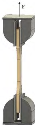
Figura 12. Esquema del ensayo a tracción
