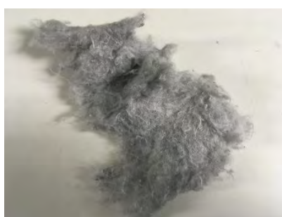
Figura 11. Residuo de fibras de algodón con tinte, provenientes de la industria textil.
