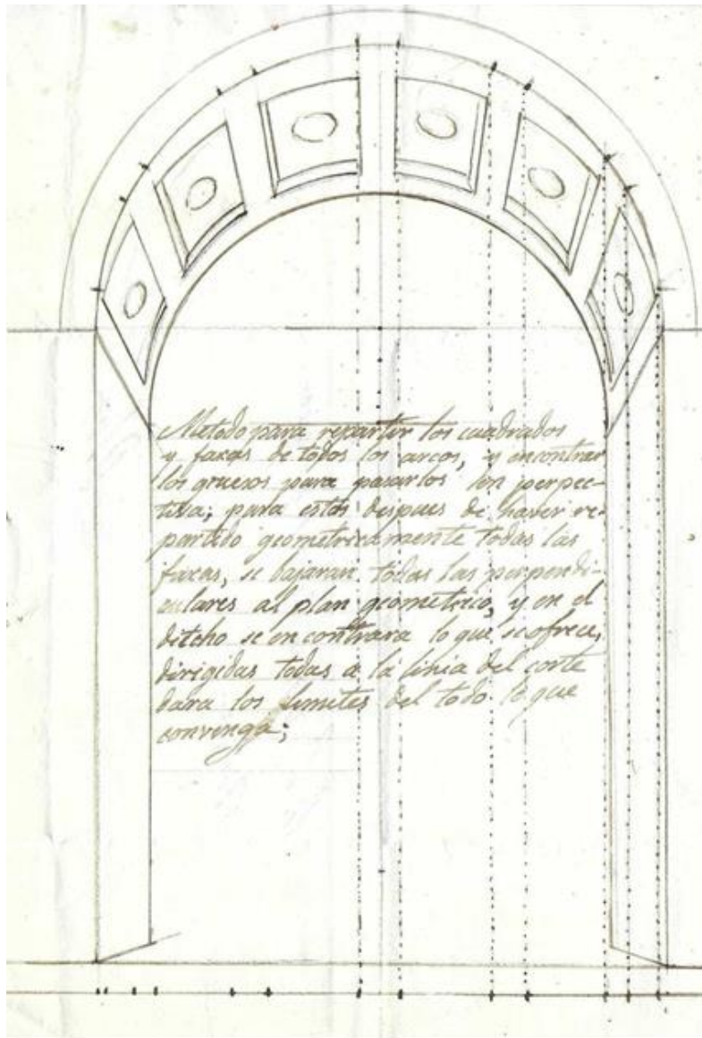
Mètode de fer els cassetons d'un arc amb perspectiva. Carta a Esteve Estorch, llapis i tinta marró sobre paper, 21 x 14'5 cm CP anvers i revers.
