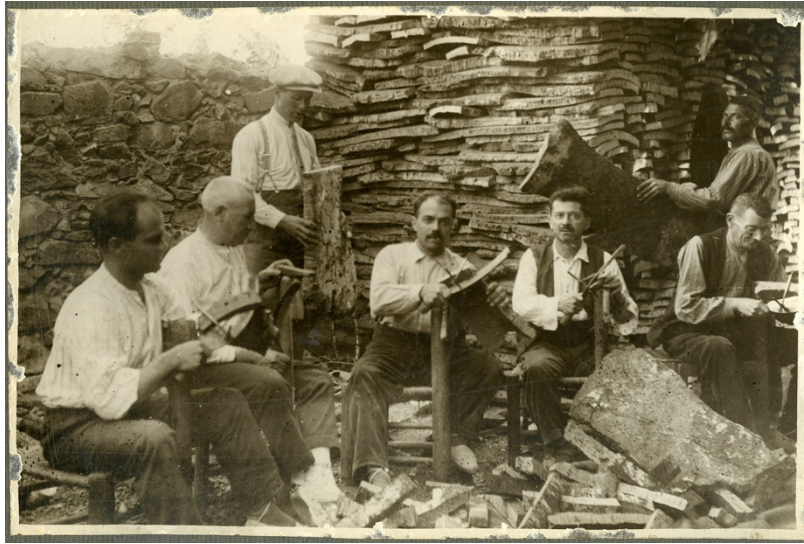
AMLLA. Col·lecció Ajuntament de Llagostera. Autor desconegut. Grup de llescadors, amb un ganivet de llescar. Quan les pannes de suro s'havien bullit i toscat, es llescaven, fent-ne tires de la mida dels taps que es volia elaborar amb un ganivet de llescar.
