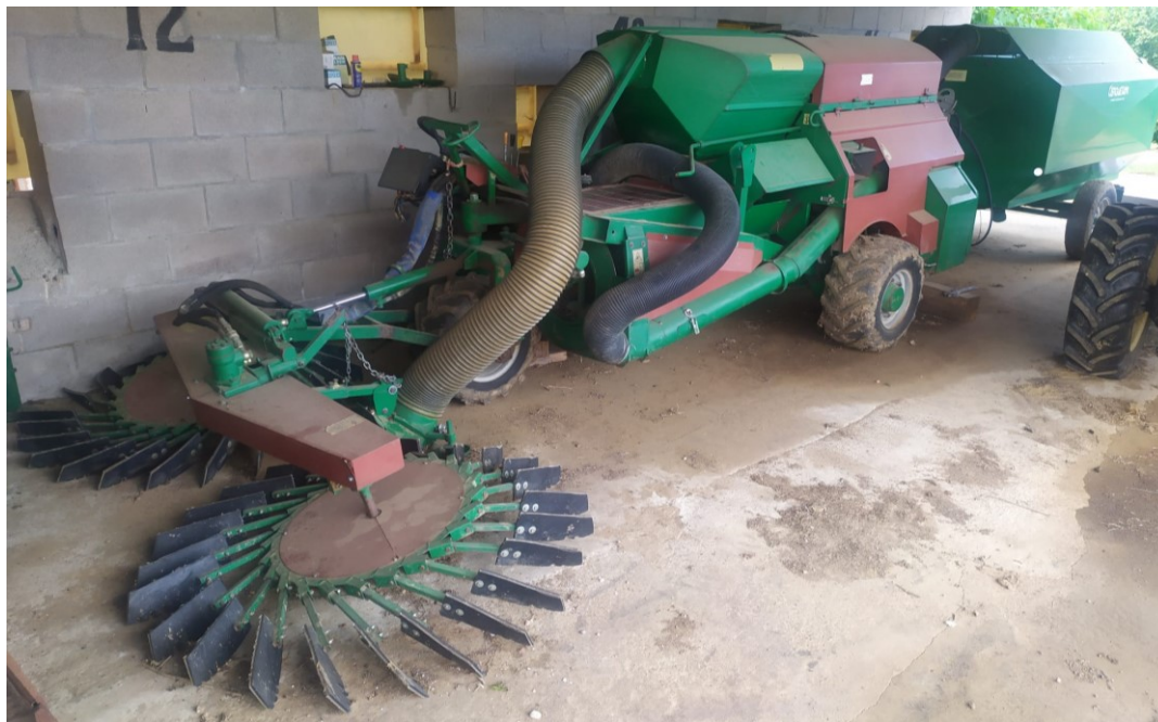
Imatge 5. Màquina recol·lectora d'avellanes moderna
