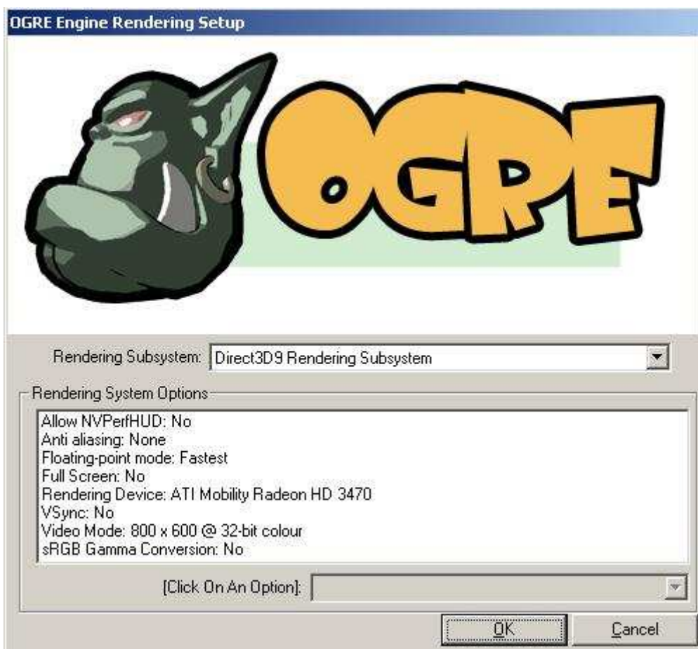
Figura 2.3.1.1 - Quadre de diàleg de configuració d'OGRE3D
