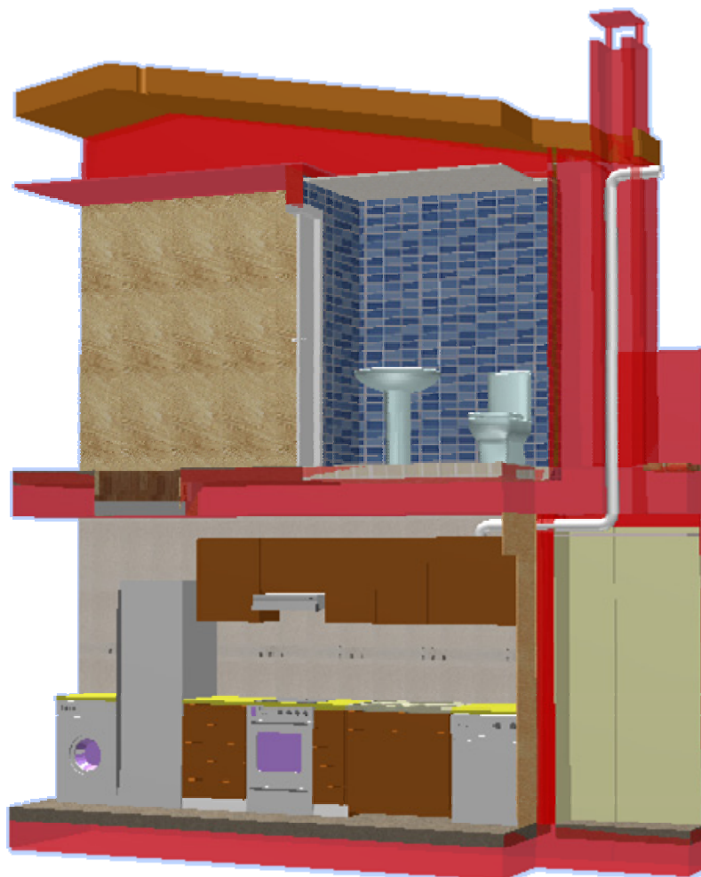
Imatge 39: Vista del recorregut del conducte de ventilació i d'evacuació dels productes de la combustió.
