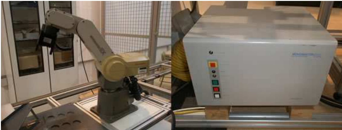
Figura 2.1: Mitsubishi Movemaster EX RV-M1 (braç articulat i unitat de control)
