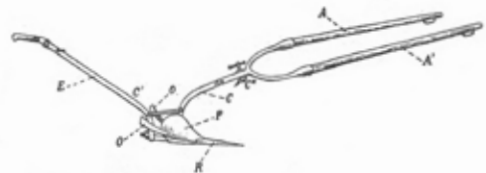
Figura 7.ª—ARADA MOSSA O POLLEGANA. A A': forca (Torelló, Calasselt); anquer (Vilaf. del P.); pollegana (Falset).—C: cameta (Vilaf. del P.).—C'-C': cametó (Torelló).—E: esteca .—O: orellera .—P: pedró (Manresa); esciop (Bassella); orelló (Torelló).—R: rellia ; panzó .
