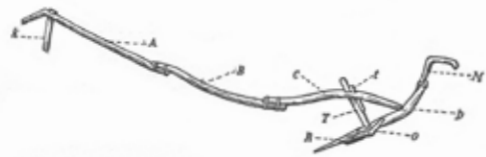
Figura 5.ª—ARADA de Menorca. A: asa .—B: àrds (Ciutadella); fosgada (Ferreries); canjo (Alaior).—C: cameta .—D: dental .—M: manll .—O: orella .—R: rellia .—T: telera .—t: refeler .—k: clauia .
