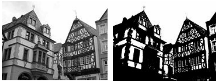
Figura 3.6 Exemple de segmentació utilitzant el mètode Otsu, a l'esquerra tenim la imatge original, i a la dreta la imatge segmentada en blanc i negre (binaritzada) [16]
