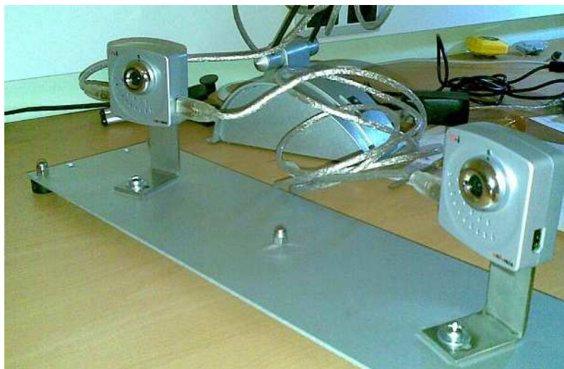
Figura 4.1. Sistema estèreo utilitzat amb un parell de càmeres Unibrain Fire-i amb resolució 640x480 píxels.
