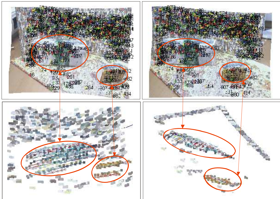
Figura 4.37. Aquí podem apreciar els punts 3D visualitzats sobre les imatges esquerra i dreta respectivament que corresponen al frame inicial de la seqüència que hem tractat a la part superior de la imatge, i a la part inferior els punts 3D al llarg de tota la seqüència on es pot veure el desplaçament que han tingut.
