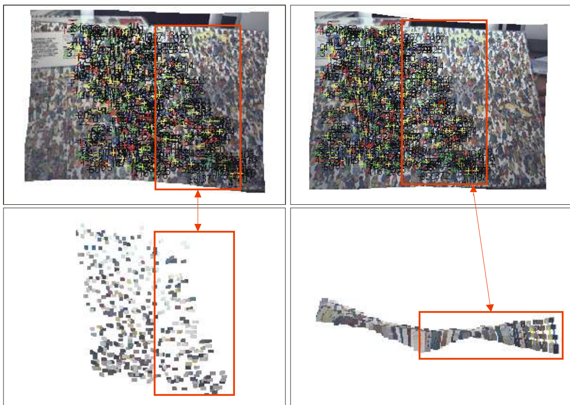
Figura 4.32. Punts 3D resultants després de l'execució del STracker per a un total de 5 frames. A la part superior els punts 3D visualitzats sobre el primer frame per la càmera esquerra i dreta, i a la part inferior el moviment que han sofert els punts 3D al llarg de la seqüència.
