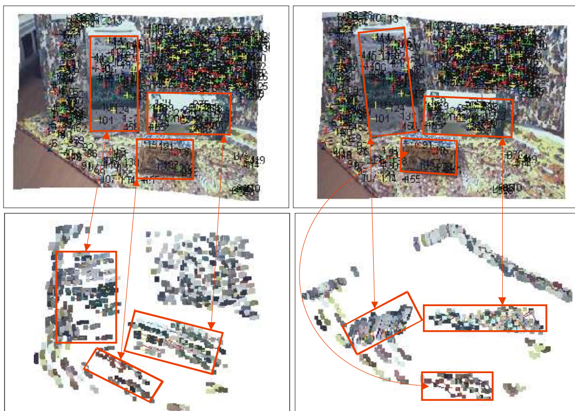
Figura 4.42. Frame inicial rectificat de la càmera esquerra i la càmera dreta amb els punts 3D que ens ha retornat el STracker. Són els punts que ha pogut seguir al llarg de la seqüència de 6 frames, tal com es mostra a la part inferior d'aquesta figura.
