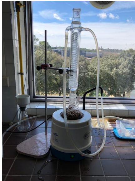
Figura 9. Muntatge de l'extracció sòlid-líquid.
