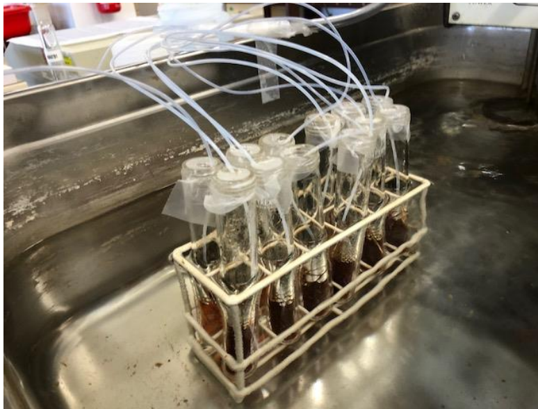
Figura 12. Muntatge dels experiments portats a terme per al disseny experimental CCI. S'observa els capilars de bombolleg de nitrogen i el bany termostàtic.
