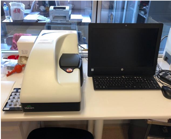
Figura 5. Aparell de Dynamic Light Scatering ZEN360 Malvern del laboratori MiMA de la Universitat de Girona (Girona, Espanya)
