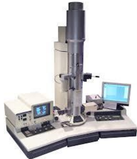
Figura 4. Microscopi electrònic de transmissió model Hitachi 8100-TEM de la Northwestern University (Chicago, EEUU).
